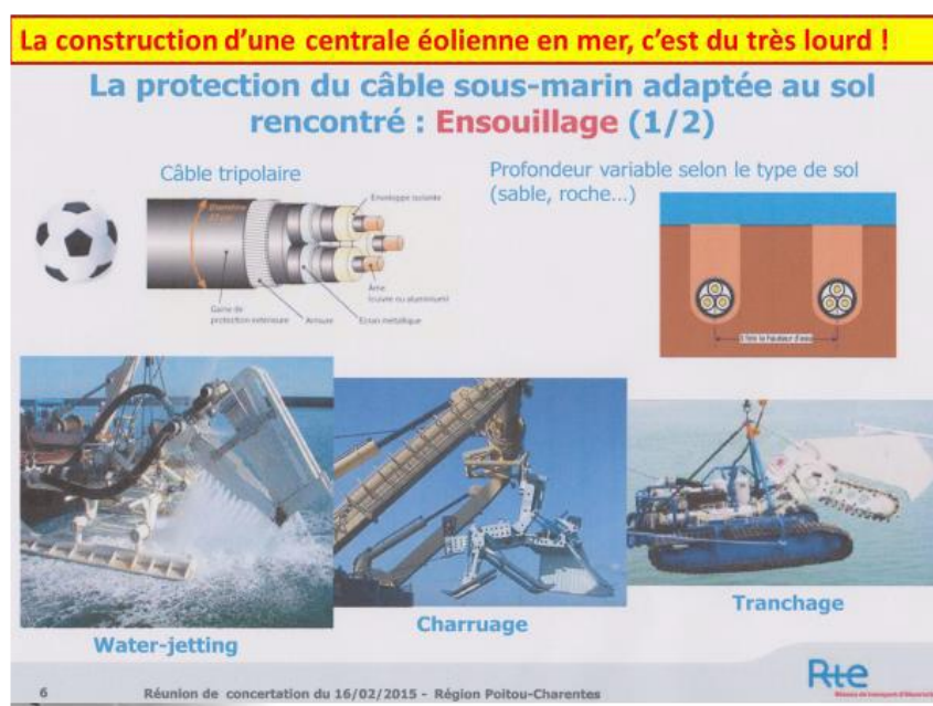
Figure 8 : câble d'atterrage, et mise en œuvre du matériel lors de sa pose.
