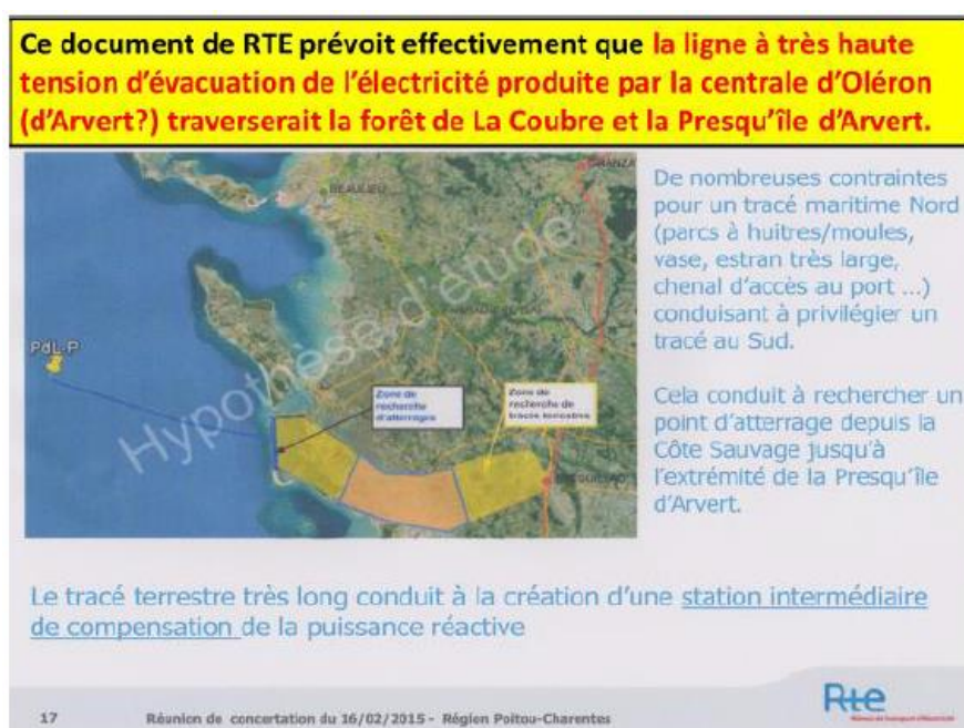
Figure 12 : zones de recherche d'atterrages et de tracés terrestres de la ligne à très haute tension envisagées par RTE pour évacuer l'électricité produite par la centrale en mer d'Oléron.
