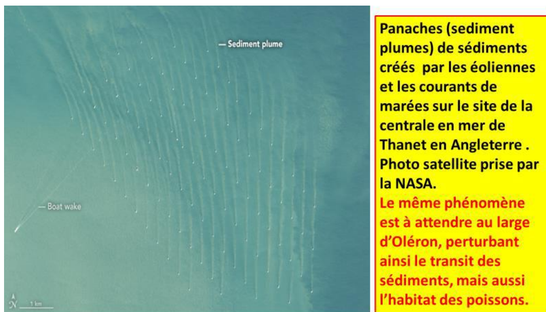
Figure 14 : vue par satellite des panaches de sédiments argileux créés par la présence des éoliennes de la centrale de Thanet au large de l'embouchure de la Tamise. Source Nasa.
