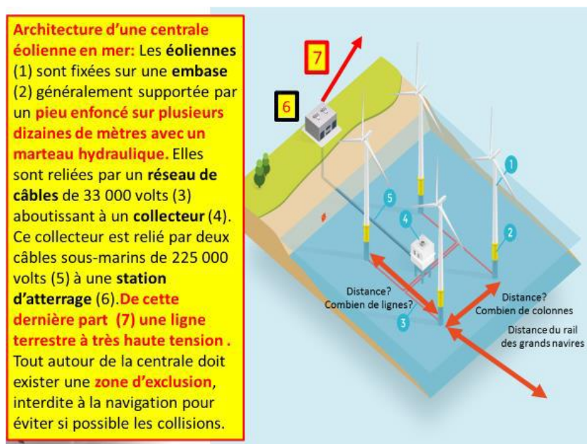
Figure 1 : Architecture d'une centrale éolienne en mer. Courtoisie JP Pervès
